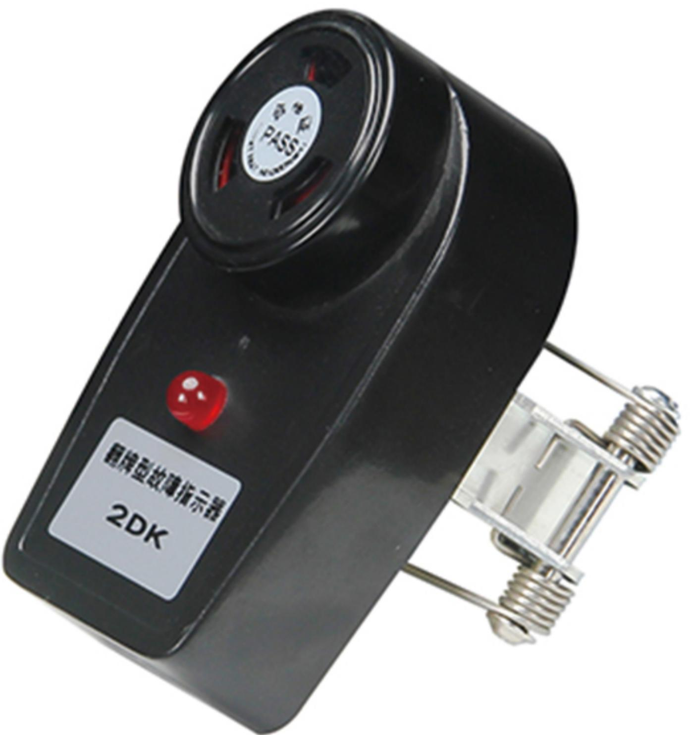
电缆型故障指示器适用于电缆分接箱、环网开关柜等电缆短路故障的检测和指示。指示器内置先进的 MCU 芯片，具有智能化、低功耗等优点。指示器面板上一只高亮度红色故障指示灯，顶部为故障翻盘指示装置。
