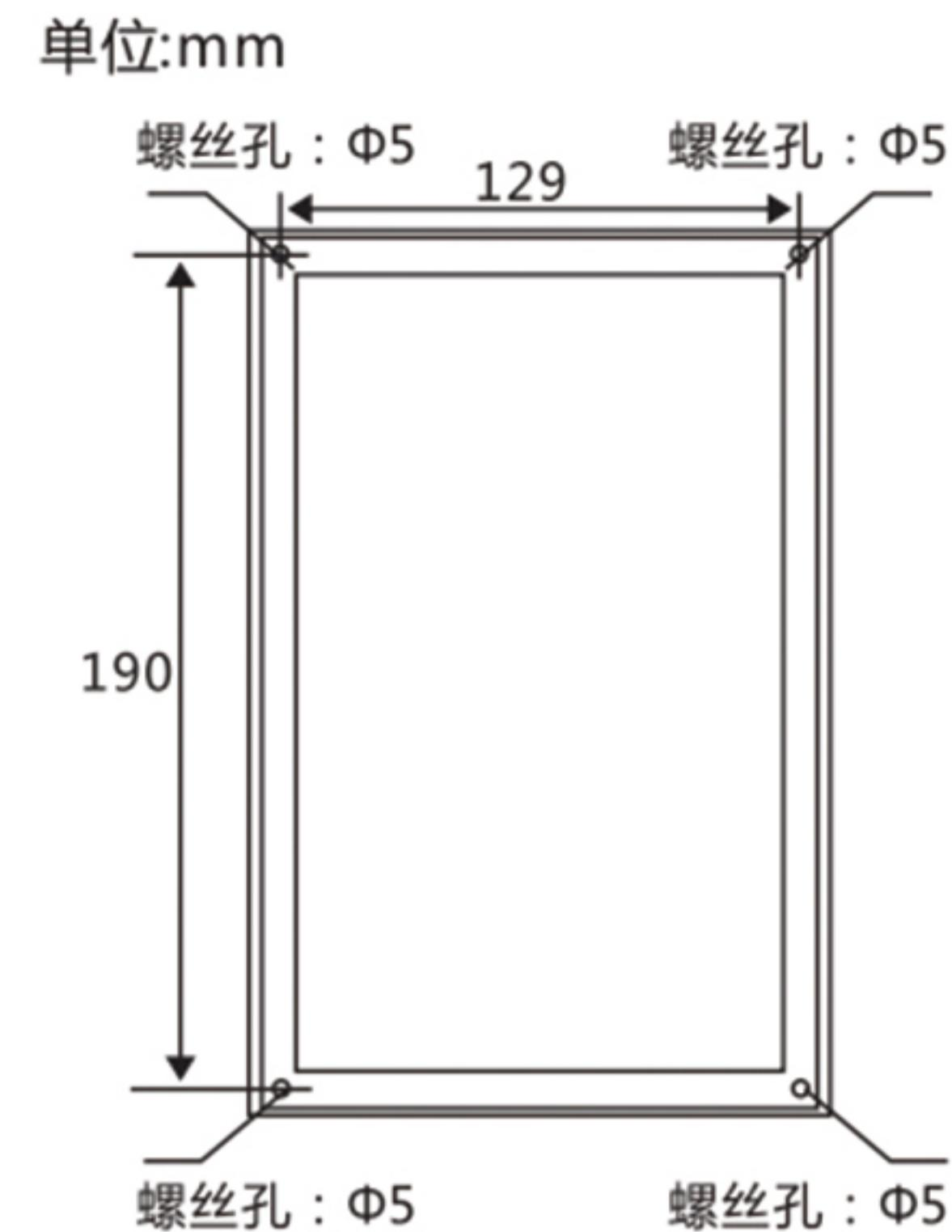
安装螺丝孔距：129mmx190mm
