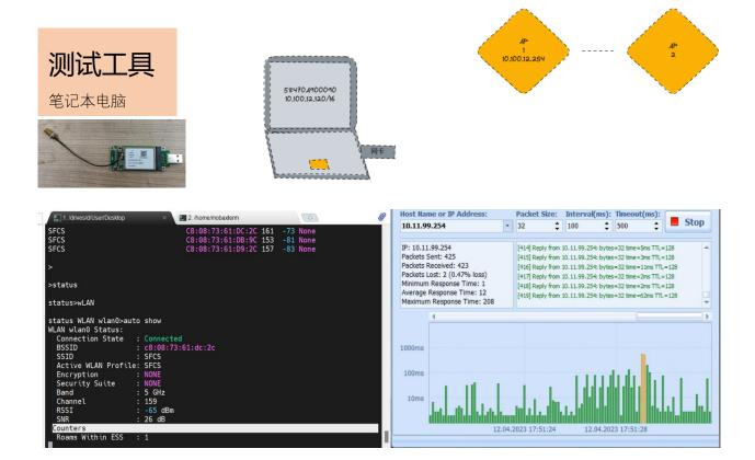
将网卡安装到计算上,通过 PING 软件,每 100ms 发送连续 ping 数据到网关,结合日志查看漫游过程。最终根据丢包的次数计算漫游时间。
