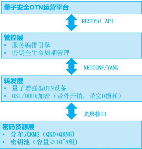
图1 量子OTN的系统设计架构
